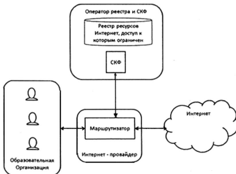
Рис.5. Схема работы контент-фильтрации при едином решении
